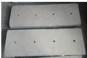
图6 自主设计、浇铸防撞铜块
