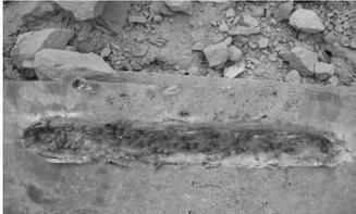
图 9 LEFP 侵彻靶板的试验结果
