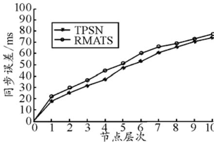
图 5 RMATS 算法同 TPSN 算法同步精度对比
