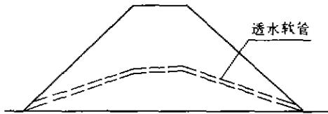
图 2 路堤下的透水软管排水系统
