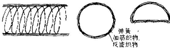
图 1 透水软管示意
