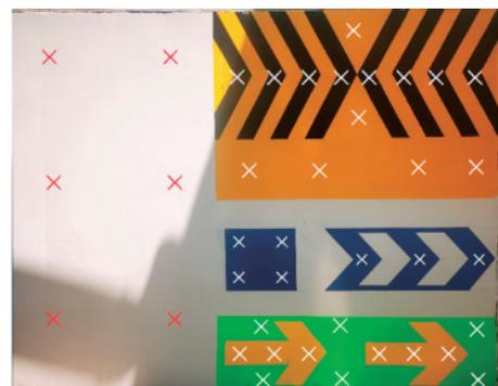
图6 水性防污涂料样板墙(x表示测点)
