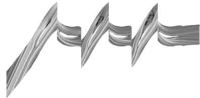
图6 压气机动叶叶尖附近流线图
