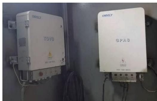
图 7 电铲内运行的 GPAS 模块和 TOVS 模块
