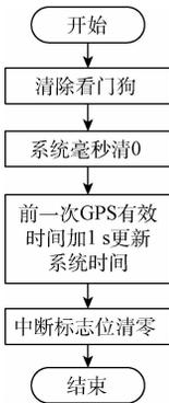
图 11 同步控制板授时中断服务程序流程
