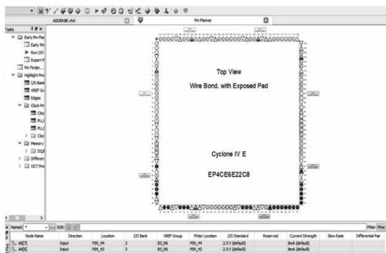
图5 FPGA管脚分配图
