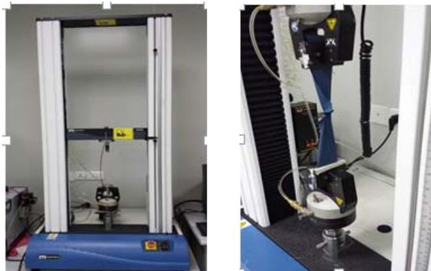
图 2 INSTRON 万能材料试验仪测试过程
