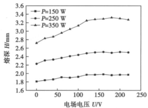
图 5 激光功率对电场作用效果的影响
