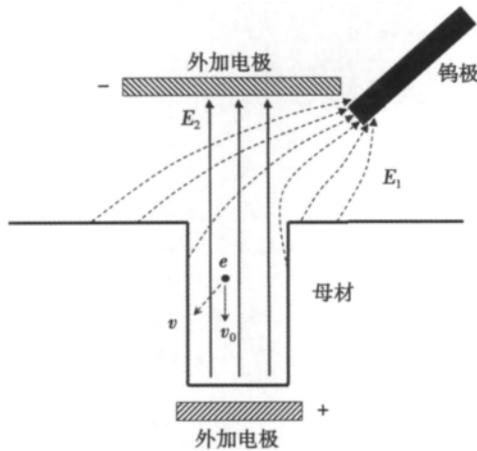
图 3 正向电场作用下小孔内电子运动示意图
