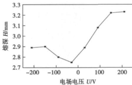
图 4 电场方向对熔深的影响
