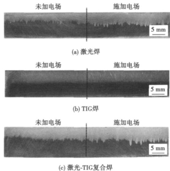
图2 外加电场对3种焊接方式熔深的影响
