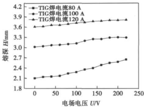
图6 TIG焊电流对电场作用效果的影响
