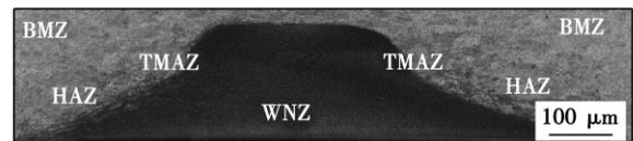
(b) 超声搅拌复合焊金相整体形貌
