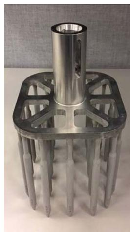
图 4 西屋公司采用增材制造工艺制备的阻流塞<sup>[4]</sup>
