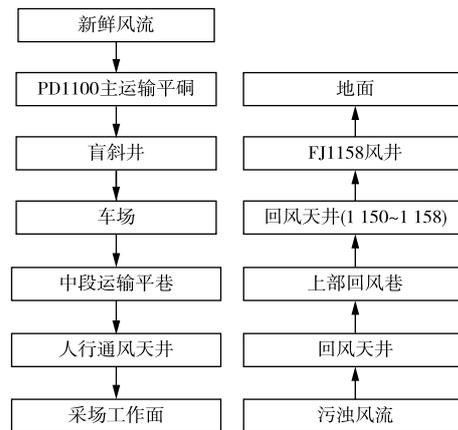
(b)1 100 m中段以下采区东翼通风线路图
