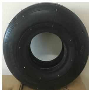
图4 生物基杜仲橡胶制备的航空轮胎
