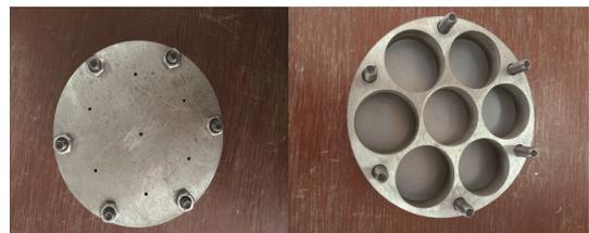
图 8 所制备的声学超材料结构
