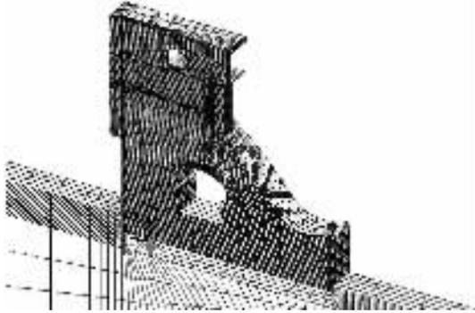
图 3 计算模型的有限元网格
