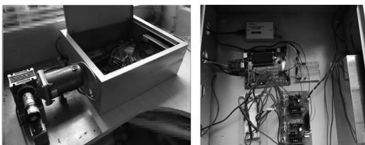
图 4 单片机控制直流脉宽调速实验装置照片
