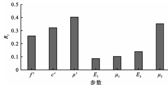
图 3 各参数对重力坝抗滑稳定可靠度敏感性分析结果
