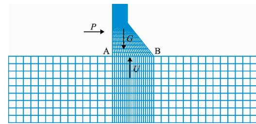
图1 算例重力坝坝体-地基有限元模型
