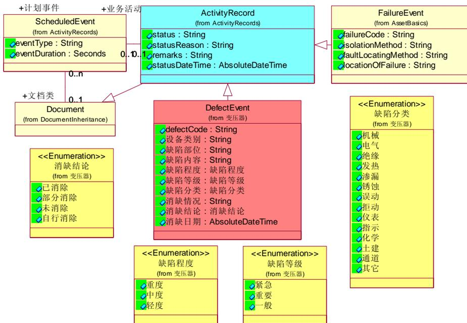
图 A7 设备缺陷信息模型
