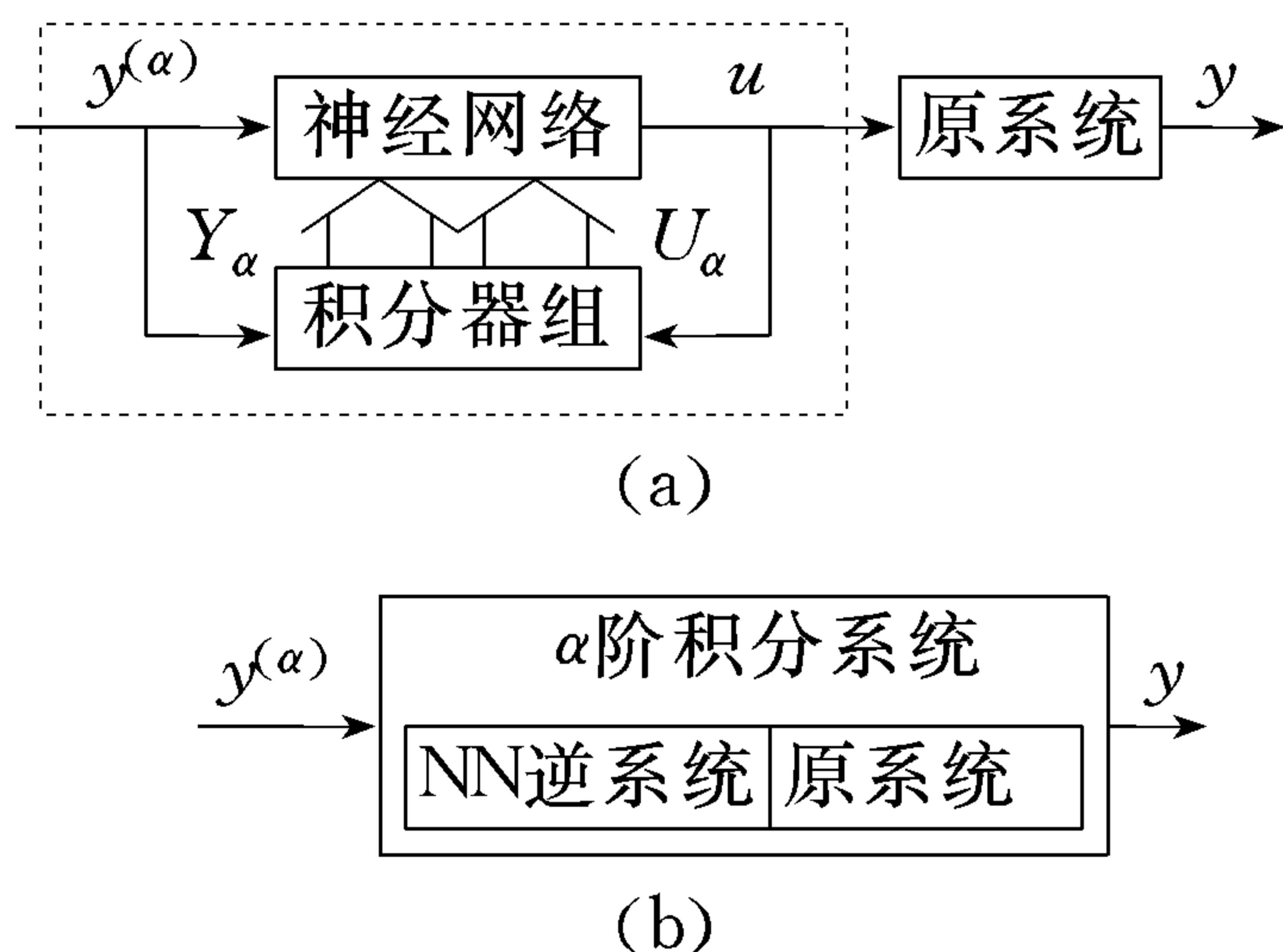
图3 连续系统的神经网络  $\alpha$  阶逆系统(a)及相应的  $\alpha$  阶积分伪线性系统(b)
