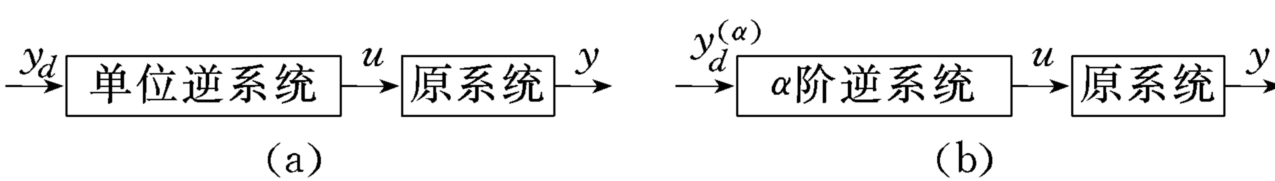
图1 单位逆系统(a)与 $\alpha$ 阶逆系统(b)示意图
