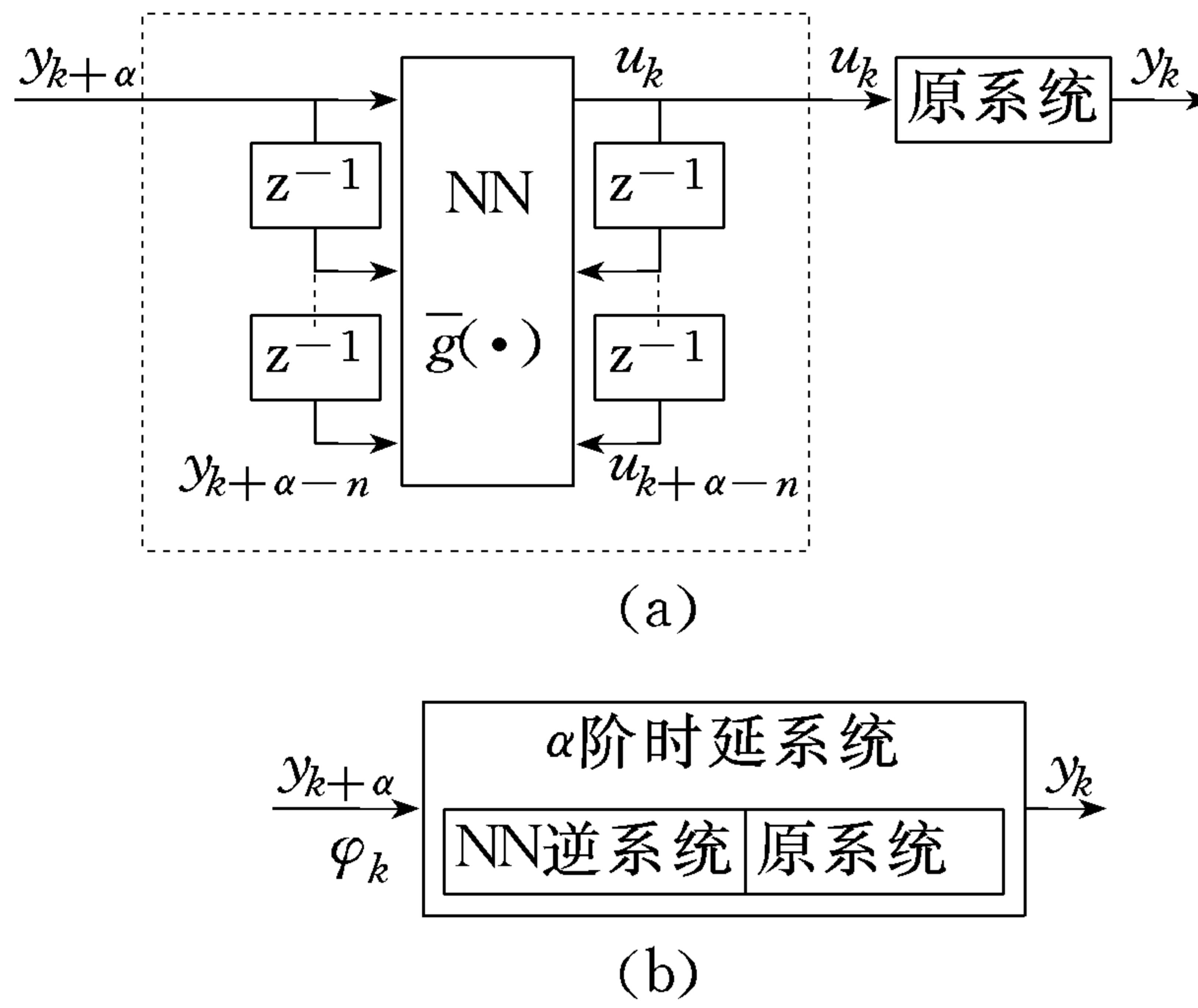
图2 离散系统的神经网络  $\alpha$  阶逆系统(a)及相应的  $\alpha$  阶时延伪线性系统(b)
