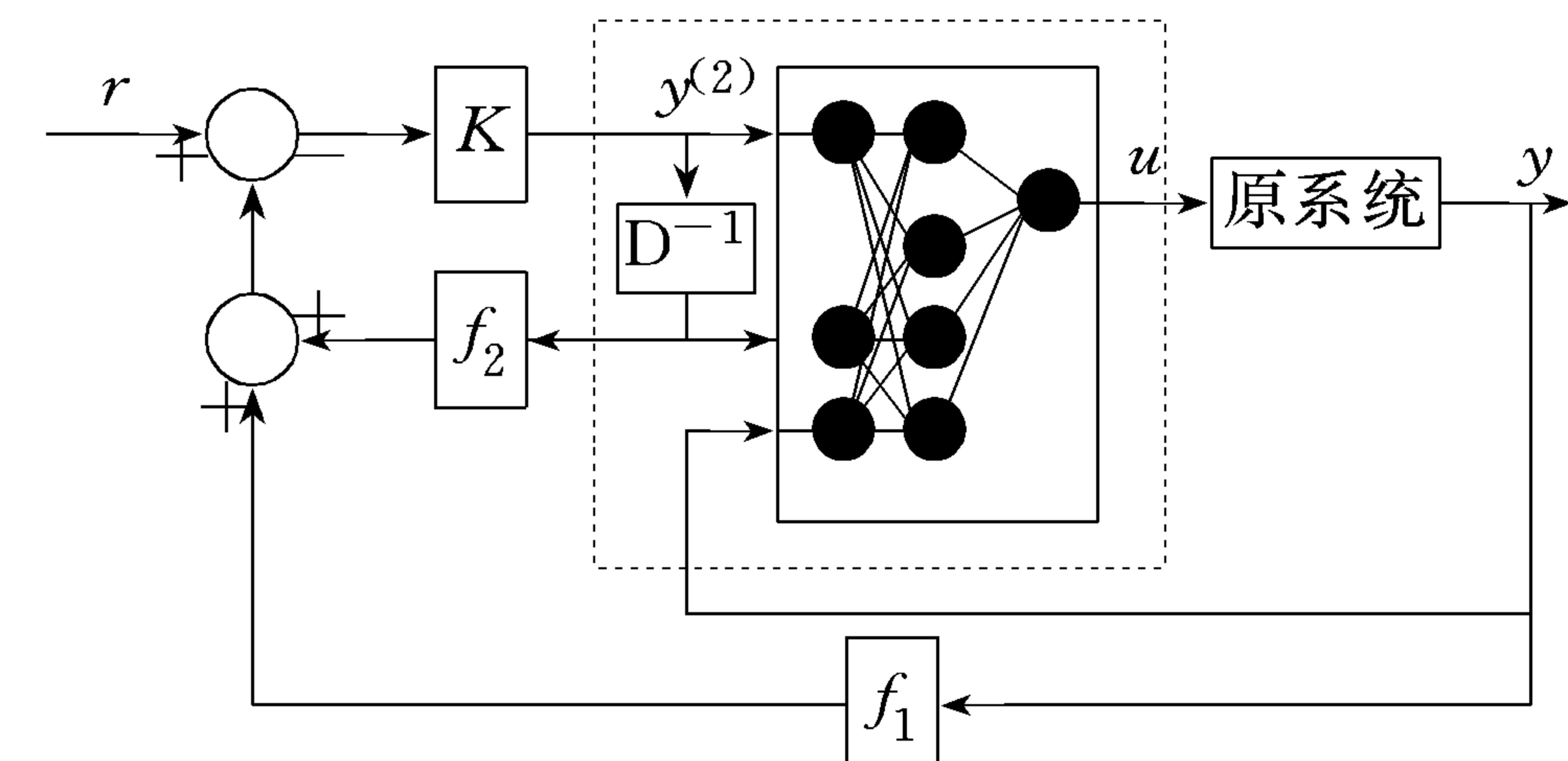
图4 对2阶伪线性复合系统采用极点配置示意图
