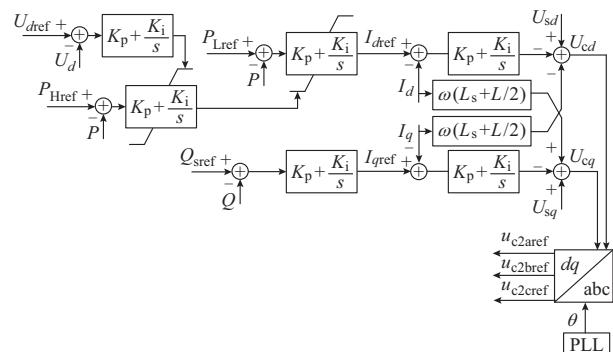
图 4 主换流站、从换流站控制器
