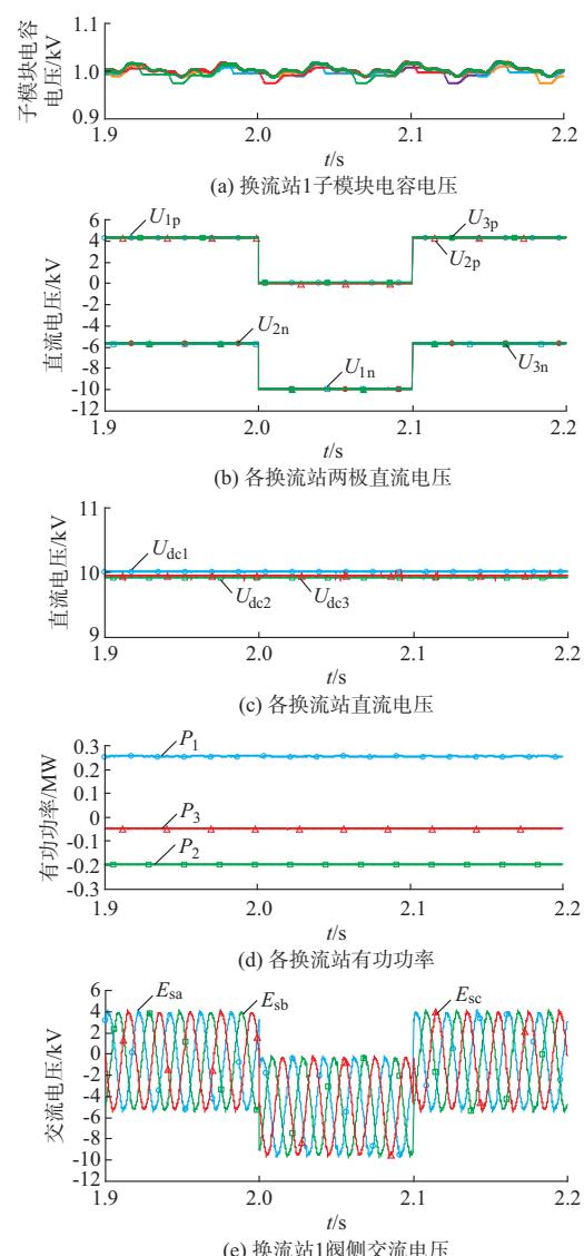
图 5 直流正极线接地故障仿真波形
