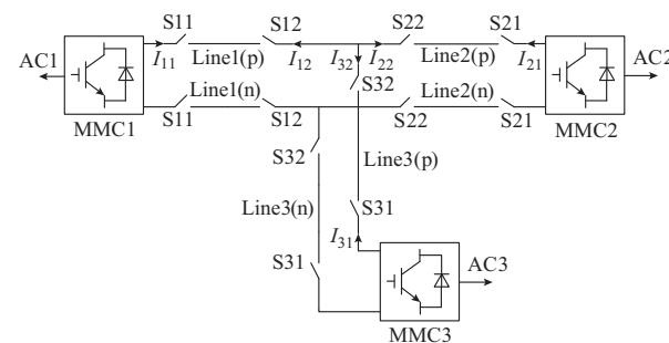
图 1 多端柔性直流输电拓扑结构
