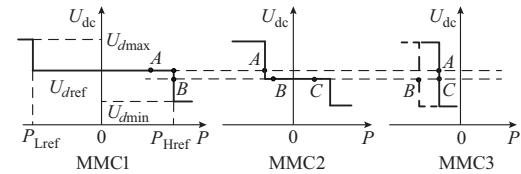
图 3 采用裕度控制的三端柔性直流输电系统控制特性
