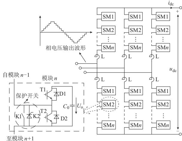
图 2 MMC 拓扑结构及其子模块的构成
