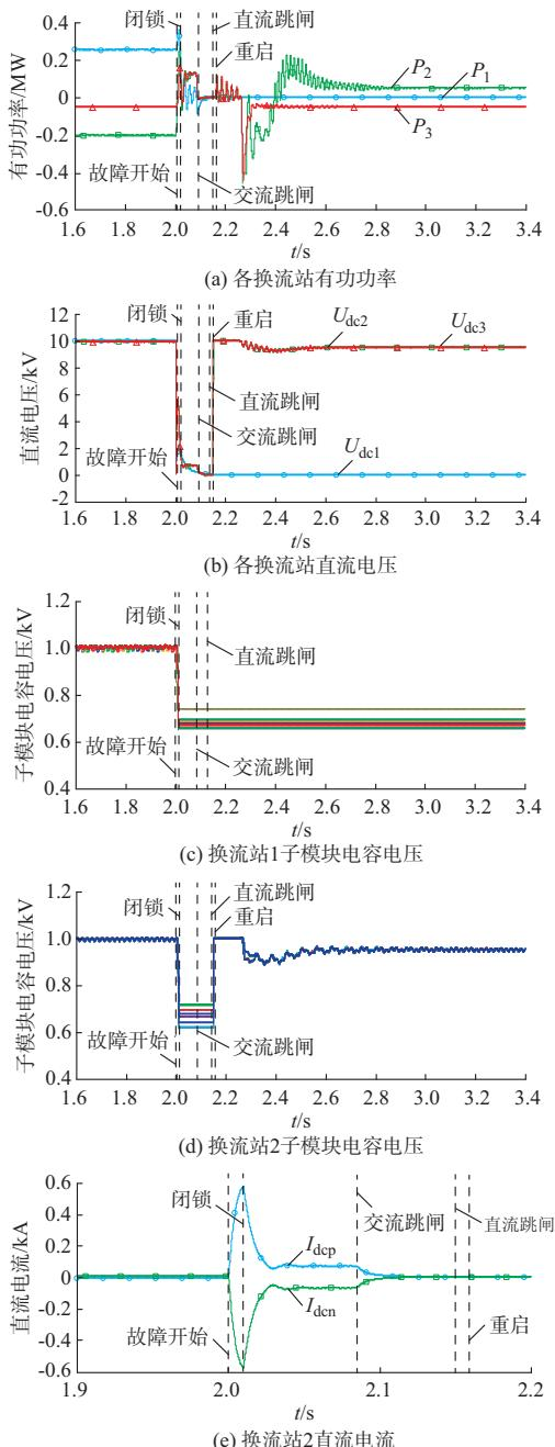
图 6 直流线路极间短路故障仿真波形
