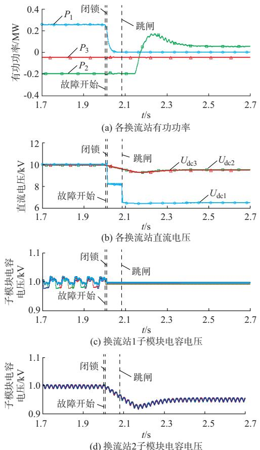
图 7 直流正极断线故障仿真波形
