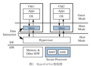
为了保持对客户OS的兼容性,HyperCoffer引入 了VM-Shim机制。如图1所示,处理器在传统的host模 式和guest模式之外,新增了一个shim模式;当状态 在host模式与guest模式之间进行切换时,都先要经 过shim模式,执行一段由处理器生产商提供的代码。 这段shim代码用于在VMM与VM之间传递必要的交互数 据,包括下陷指令、页表项值、I/O数据等,从而使 得VM不需要经过修改即可在HyperCoffer上运行。通 过一层实现简单的软件层,HyperCoffer修复了安全 处理器与虚拟机监控器之间的语义鸿沟,很好的解决 了传统安全处理器需要大幅修改上层软件的问题。 HyperCoffer中,安全可信基(Trusted Computing Base,TCB)仅包含安全处理器与VM-Shim 软件层,其他的软件与硬件组件均为不可信,从而进 一步缩小了TCB。其中,Shim的数据和VM的数据均由 安全处理器保护。
