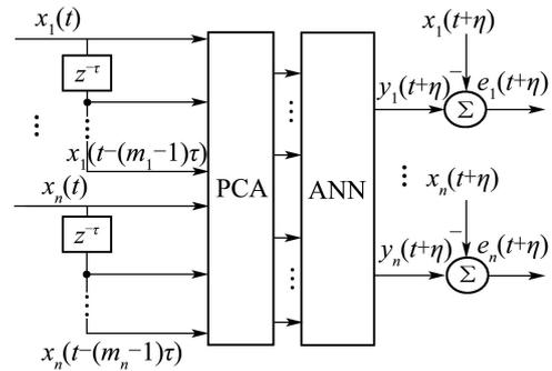
图 1 多元变量预测模型基本结构
