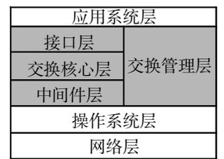
图 4 公共数据交换节点内部的层次结构
