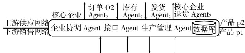
图 4 基于多智能代理的供应链订单处理体系结构
