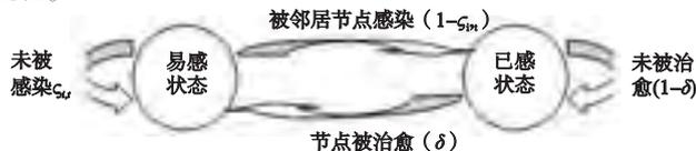
图1 节点状态转换过程图
