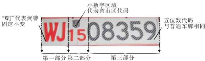
图 5 武警车牌结构示意图
