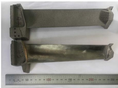
图 9 电子束增材制造 Ti-48Al-2Cr-2Nb 合金 LPT 叶片<sup>[51]</sup>
