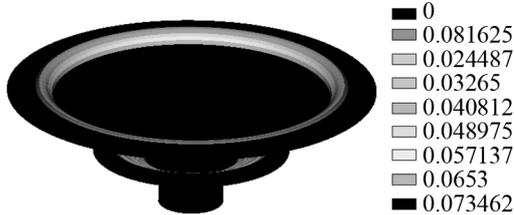
图7 扬声器在 1 阶固有频率处的 Z 方向振幅
