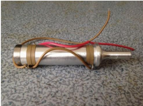
图 8 推挽激励换能器实物图
