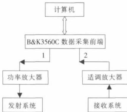
(1-前端输出信号端口 2-前端输入信号端口)
