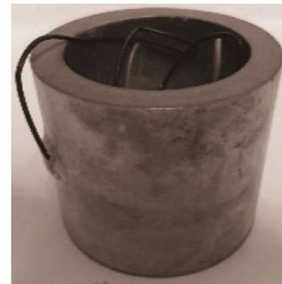
图 2 压电换能器实物图
