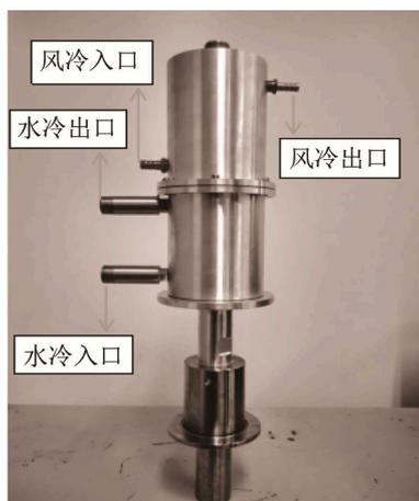
图 9 换能器样机实物图
