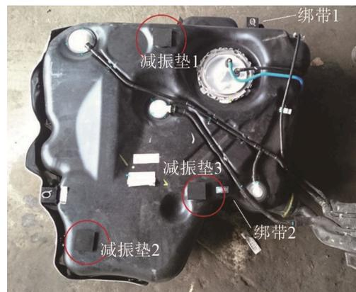
图 4 实验用油箱减振垫和绑带位置
