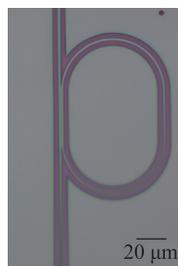
图 1 悬空跑道谐振器显微镜图像
