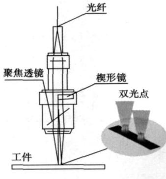
图 1 双光点激光焊接原理
