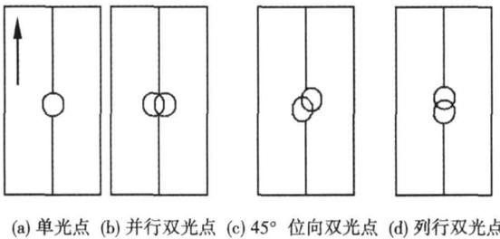
图 2 光点位向与焊接方向的关系
