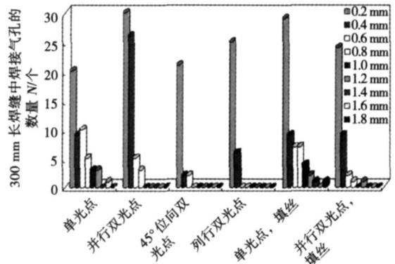
图5 300 mm长焊缝中不同直径气孔数量统计结果
