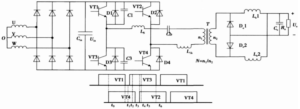
图 1 零电压零电流倍流整流变换电路
