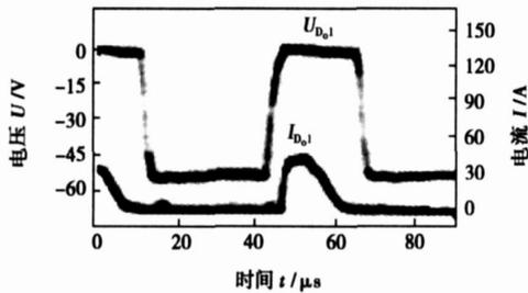
(c) 整流二极管电压与电流波形
