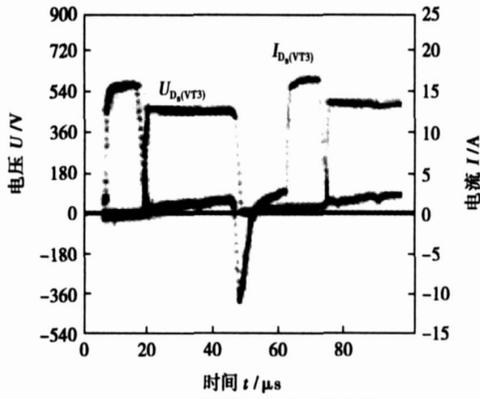
(a) 超前桥臂电压与电流波形
