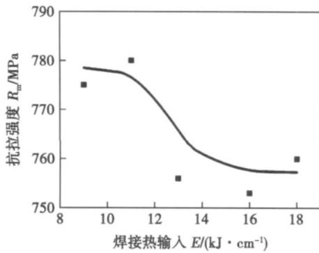
图 3 接头抗拉强度与焊接热输入的关系
