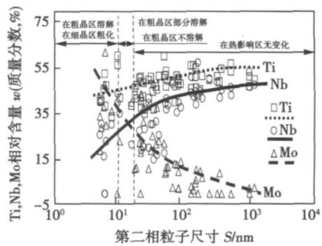
图 10 Ti, Nb, Mo 元素析出相对含量与第二相粒子尺寸关系
