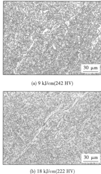
图 5 不同热输入焊缝显微组织
