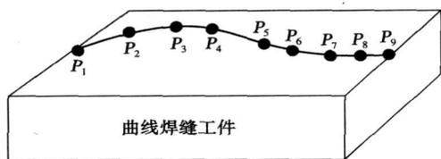
图 3 曲线焊缝示教点位置模型
