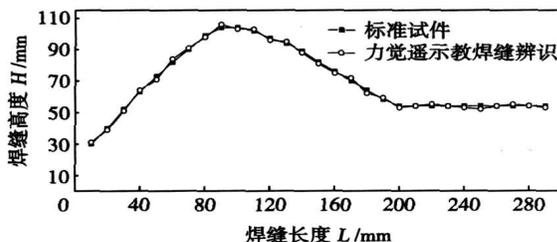
图 5 曲线焊缝位置辨识试验
