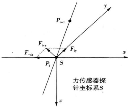
图1 曲线焊缝任意点受力示意图
