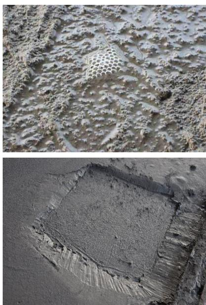
图2 混凝土冒泡和整体膨胀现象
