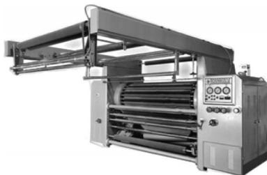
图 16 油压式高速起毛机
